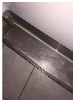
Cracked bottom door shelf
